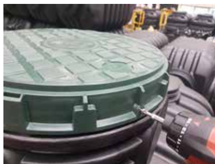
2. Umieścić wkręty INOX 4.8x32 w otworach znajdujących się w pokrywie, następnie wkręcić je
